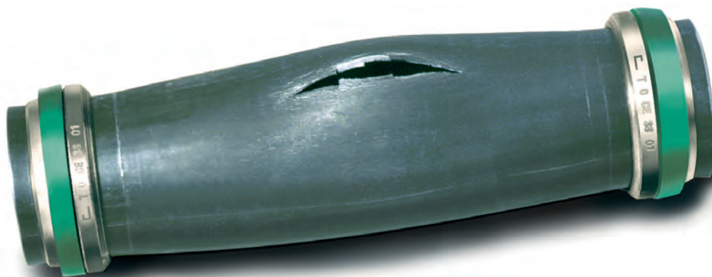
Prova distruttiva con tubo in acciaio al carbonio 28x3. Il tubo è scoppiato a 1050 bar, senza registrare perdite o trasudamenti nei punti di tenuta.
