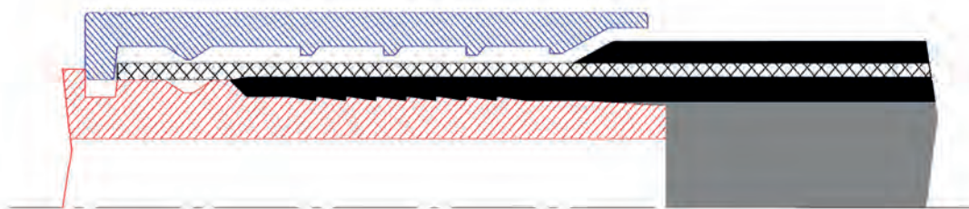
Prima della pressatura della boccola sul tubo pelato
