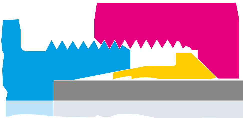
Après montage sur le tube métallique
